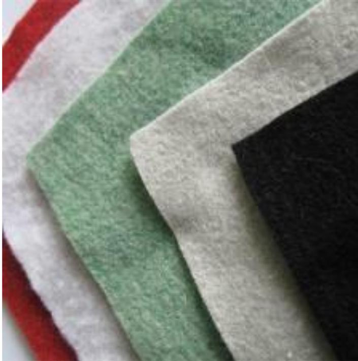
**El Geotextil NO tejido se define como un material textil sintético plano permeable enrollable fabricado de filamentos o fibras entrelazados en forma regular o aleatoria por medios mecánicos térmicos o químicos con el fin de darle condiciones especiales al manto Diseñado ex profeso para interactuar con el suelo**
