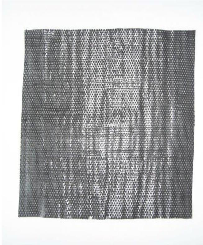
**El Geotextil Tejido plano se define como un material textil sintético plano permeable enrollable de dos o mas conjuntos de hilos filamentos tiras o fibras tejidos en forma de trama y urdimbre Diseñado ex profeso para interactuar con el suelo**
